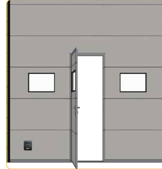
Düşük Eşikli Servis Kapısı Uygulaması
